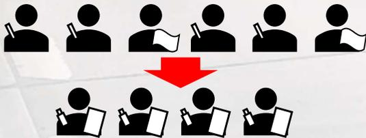
従来のトンネル点検の体制は、検査者4人、野帳記録者2人の1チーム6人/日が標準※とされています。本装置ではマーキングと記録を同時に行えるため、検査者4人だけで点検が可能となります。
